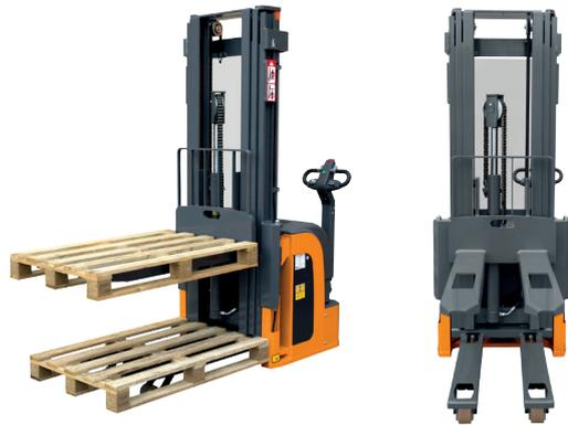
Die Wartung kann dank einer großen Öffnung am Chassis mühelos ausgeführt werden und das Antriebsrad kann ausgetauscht werden, ohne den Wagen anheben zu müssen. Die neuen Abdeckungen aus Polyethylen mit erleichtertem Öffnungssystem garantieren während der ordentlichen und außerordentlichen Wartung den Zugriff auf alle Komponenten.
